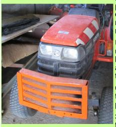
L'engin utilisé pour la tonte des espaces verts et des accotements présentait ce petit défaut d'éjecter l'herbe latéralement. En fonction du déplacement du tracteur, une partie de la tonte pouvait parfois se retrouver rejetée sur la chaussée ou, dans l'autre sens, venir crépir les murs proches.
